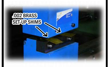
2. ADJUST TOOL UNTIL CUTTING EDGE IS AGAINST THE SET-UP SHIM TO MINIMIZE CLEARANCE.
